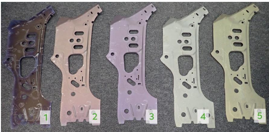
Obr. 8 – Díly prověřené metodou vířivých proudů
