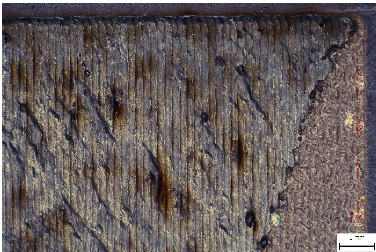
Obr. 69 – Částečně odpařený povlak při výkonu 120W, v_p = 500 m/min a rozteči 0,2 mm.
