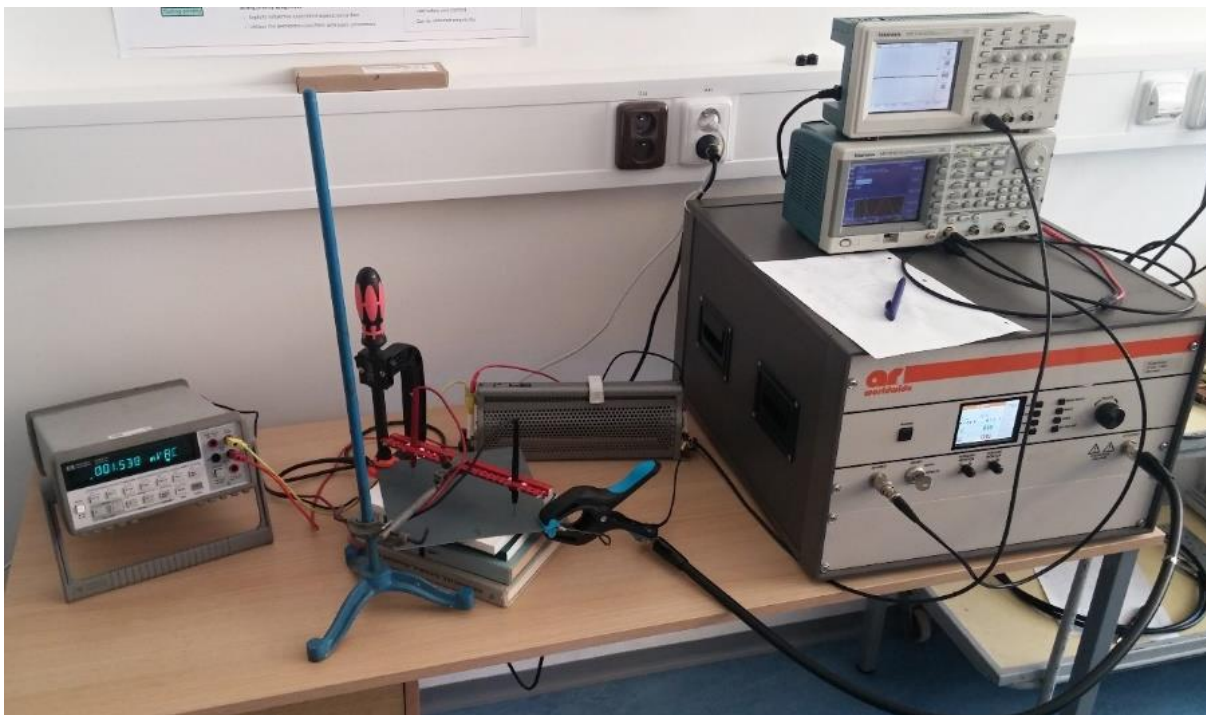
Obr. 31 – Obvod pro měření úbytku napětí s využitím střídavého proudu.
