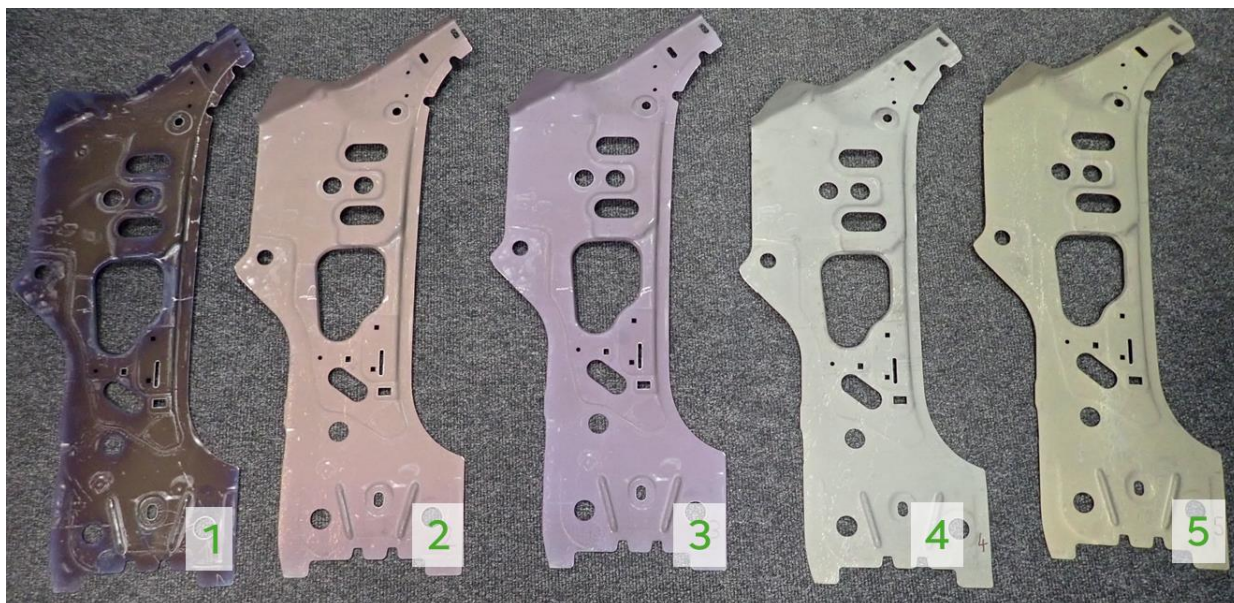
Obr. 78 – Díly prověřené metodou vířivých proudů
