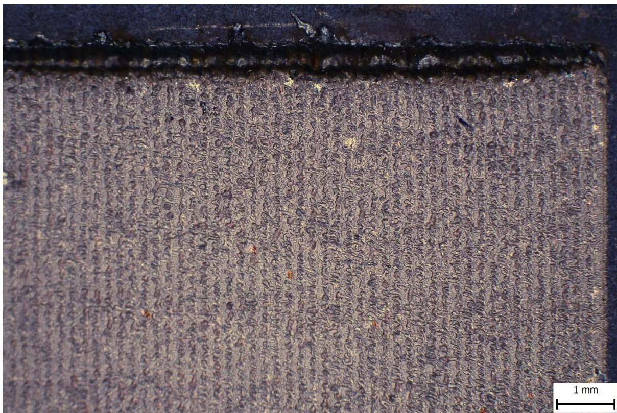
Obr. 68 – Kompletně přetavený povlak při výkonu 100W, rychlosti posuvu 1000 m/min a rozteči 0,2 mm.
