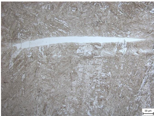
Obr. 9 – Intermetalika Al-Fe ve svarové čočce.
