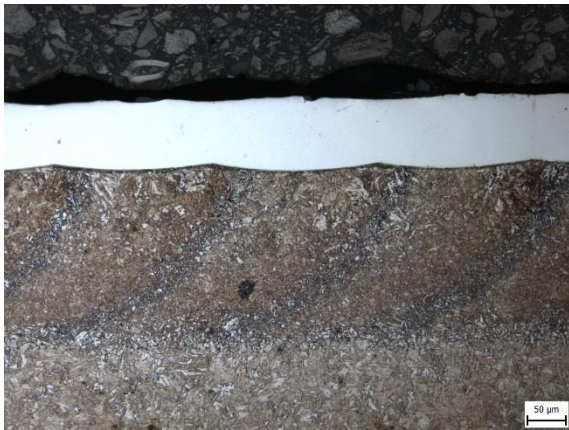
Obr. 13 – Homogenizovaný povlak s výraznou TOO.
