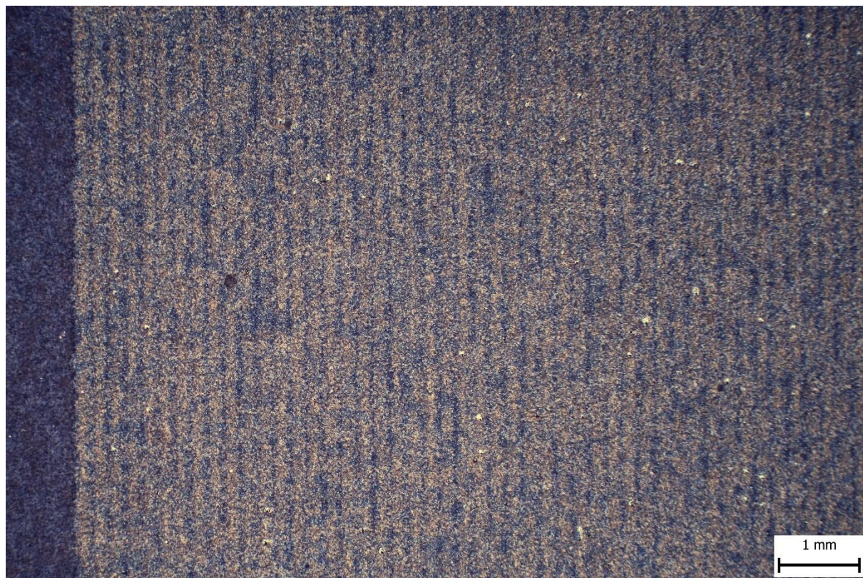
Obr. 67 – Laserem homogenizovaný povlak při výkonu 30W, rychlosti posuvu 500 m/min a rozteči stop 0,2 mm.
