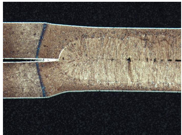
Obr. 10 – Defekt na hranici ztavení.
