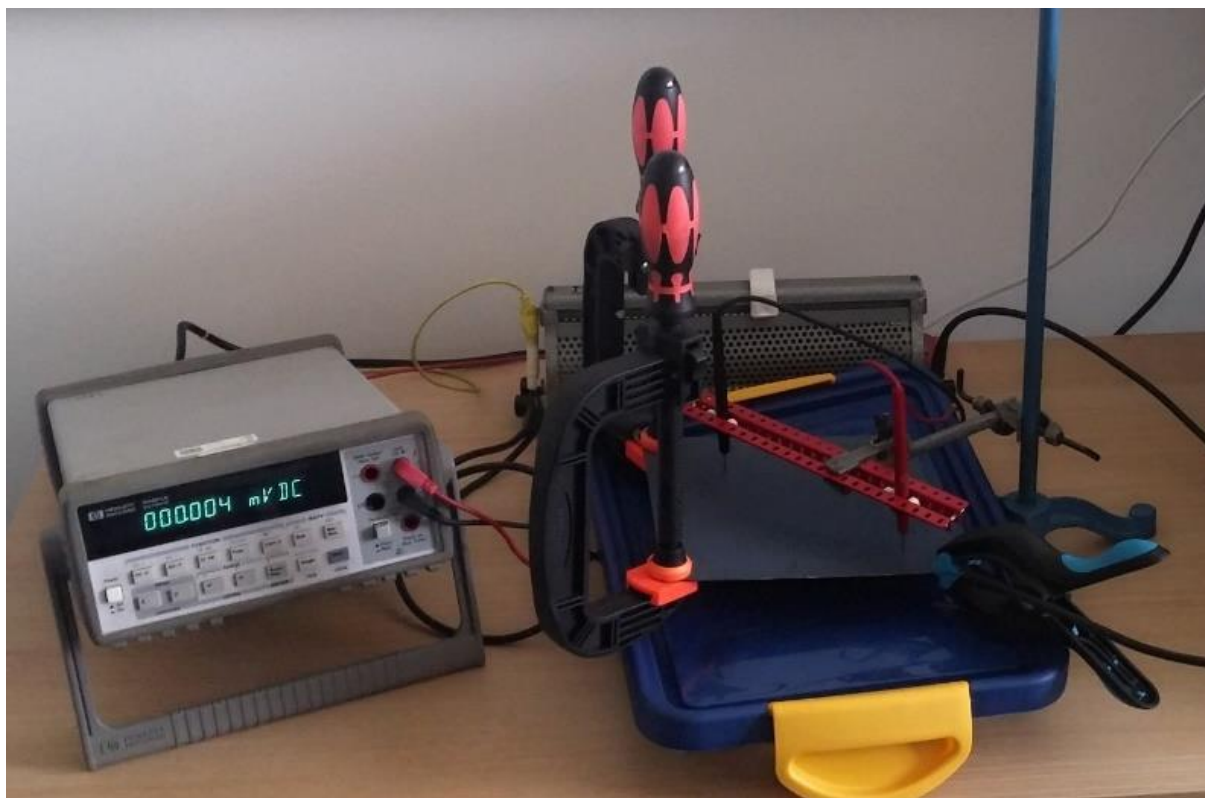
Obr. 30 – Zapojení obvodu pro měření úbytku napětí s využitím stejnosměrného proudu.
