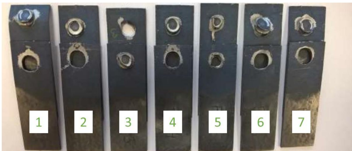
Obr. 64 – Vzorky austenitizované po 420 s po roztržení.
