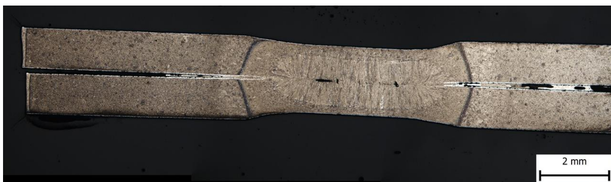
Obr. 21 – Metalografický výbrus bodového svaru oceli 22MnB5.
