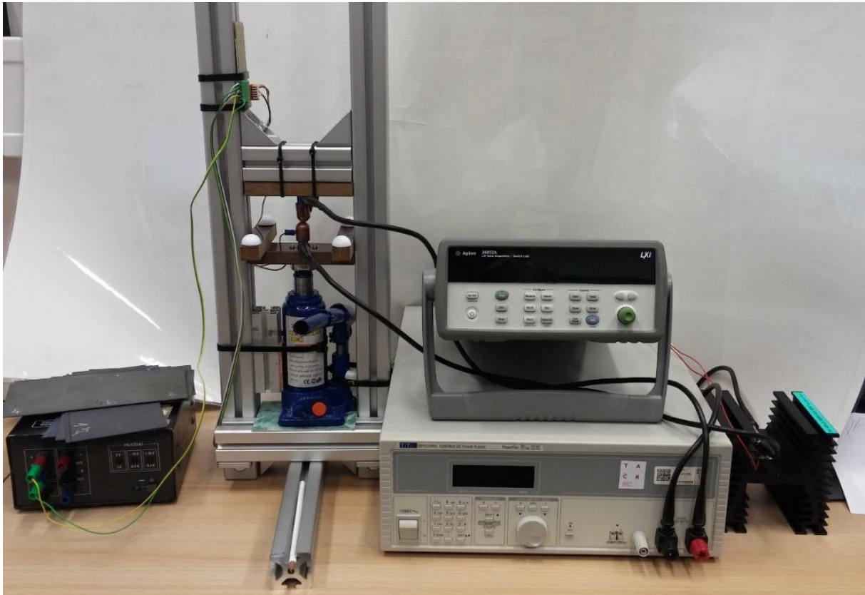
Obr. 32 – sestrojený přípravek pro měření elektrického odporu čtyřsvorkovou metodou zapojený v obvodu.
