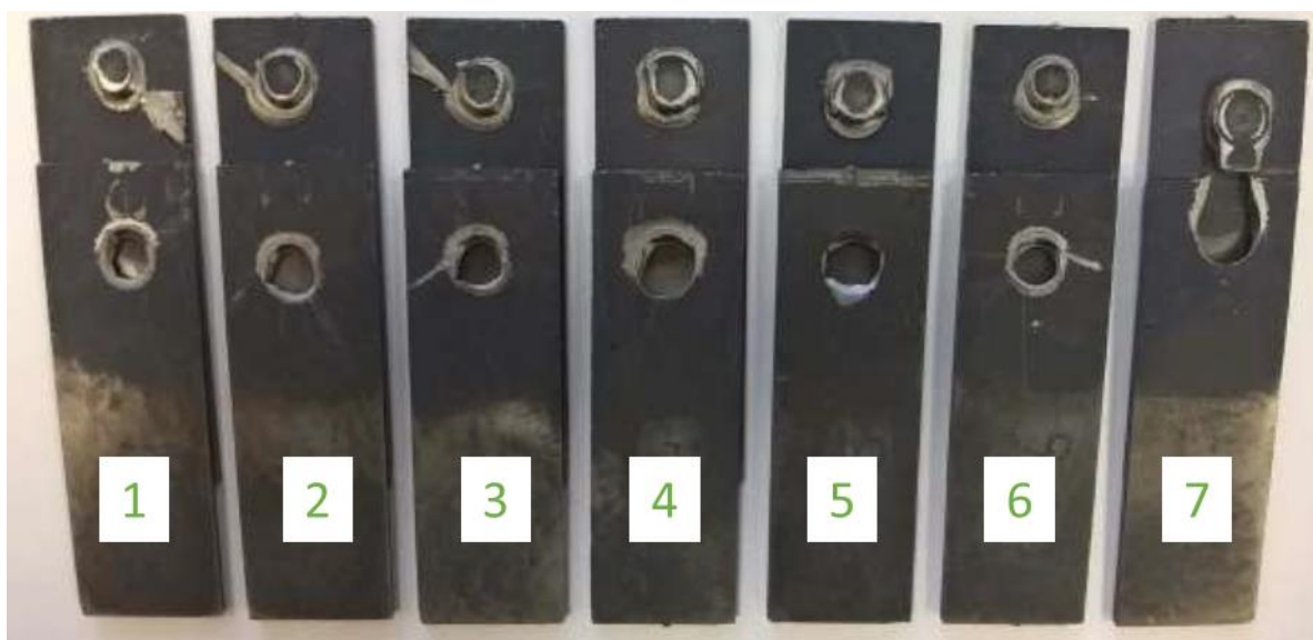
Obr. 63 – Vzorky austenitizované po 300 s po roztržení.
