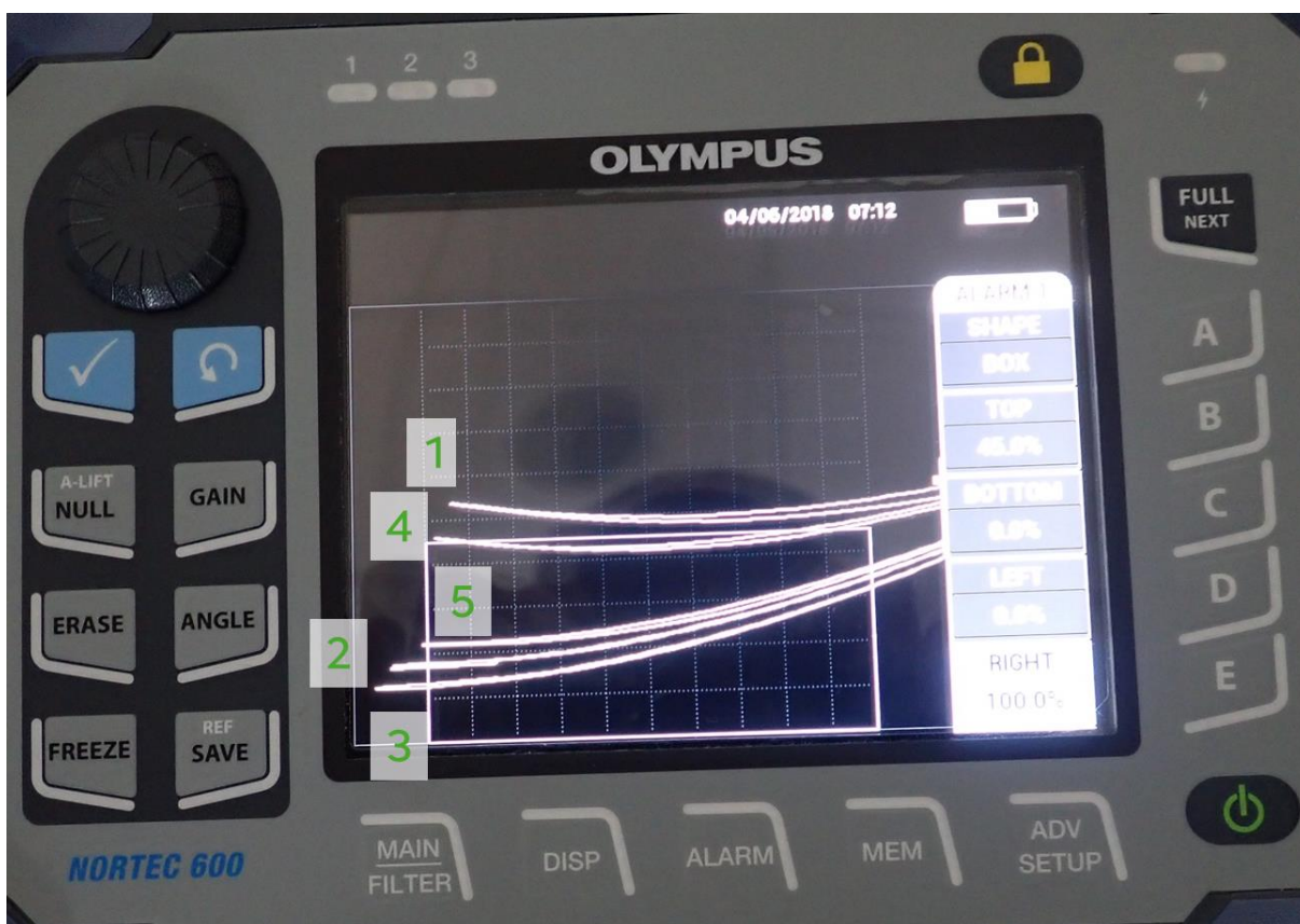
Obr. 84 – Záznam měření vzorků v impedanční rovině.
