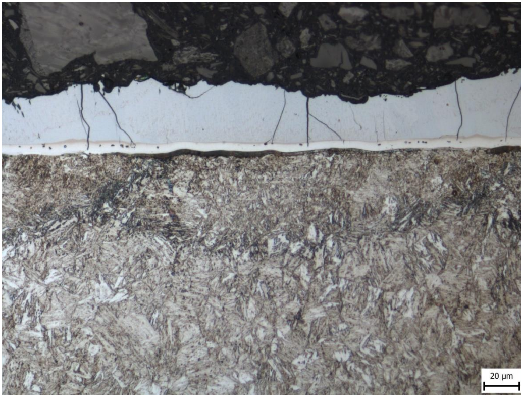
Obr. 74 – Vzorek s homogenizovanými subvrstvami povlaku a nehomogenizovanou difuzní vrstvou.
