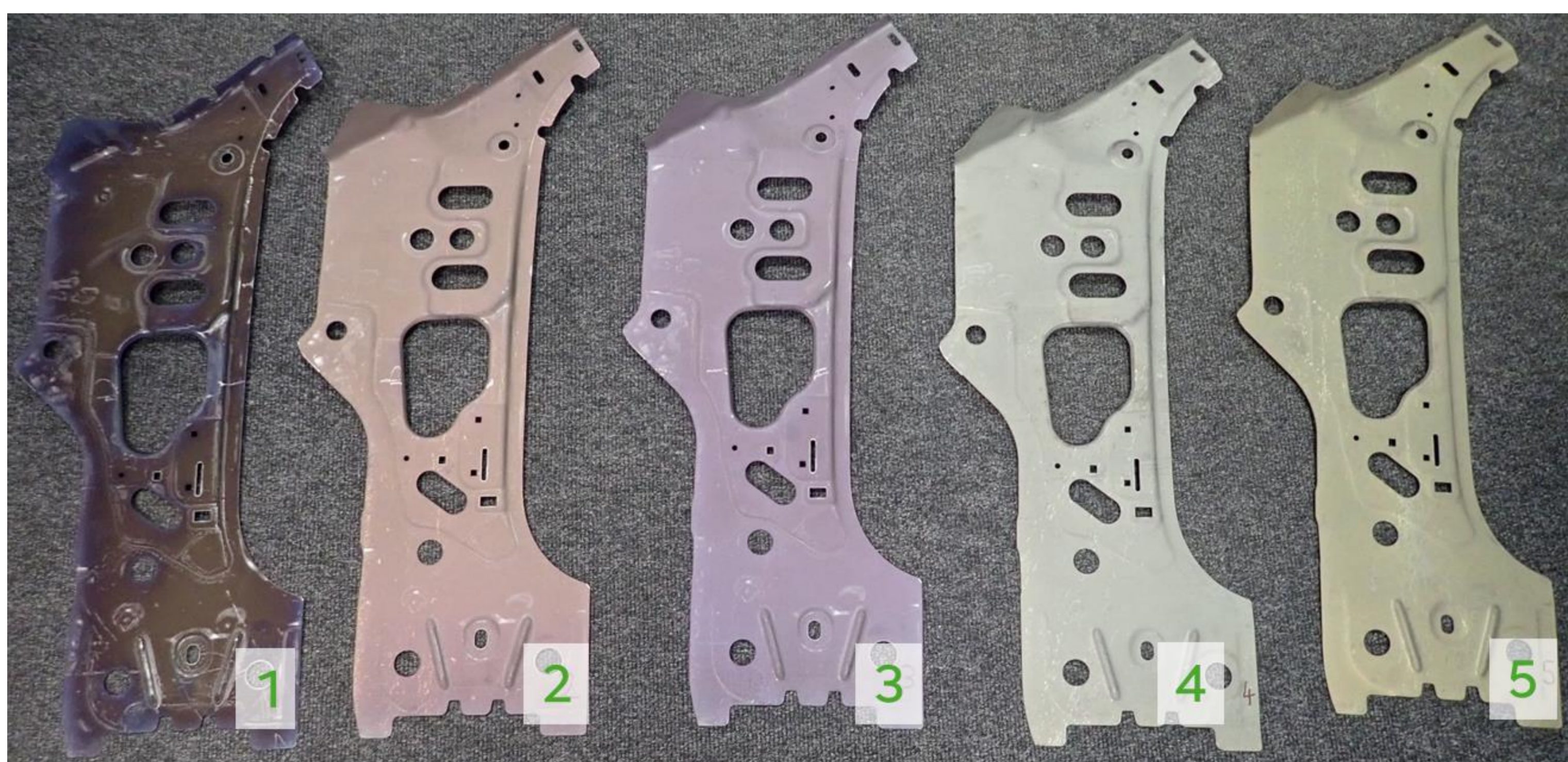
Obr. 1 – Díly z oceli 22MnB5 + AS 150 po termomechanickém zpracování s rozdílnými parametry
