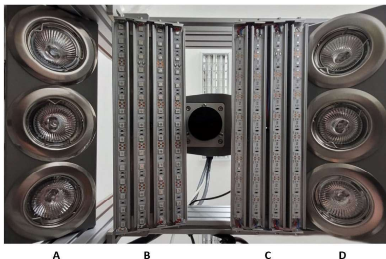
Obrázek 5.2: Osvětlení stolu hyperspektrální kamery: A a D - halogenové lampy, B - UV LED pásky, C - modré LED pásky
