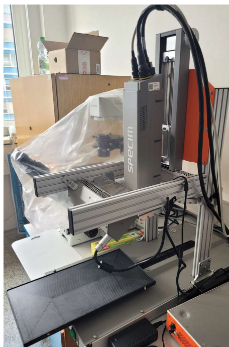
Obrázek 5.1: Hyperspektrální soustava v laboratoři katedry radioelektroniky
