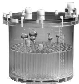
Obrázek 1.2: Jaszczak SPECT fantom. Vnitřní struktury byly při měření vyjmuty. Převzato z [19].
