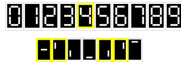
Obr. 3: Príklad distribuovanej reprezentácie čísla 4. Prvý riadok ukazuje tréovaciu množinu jednoduchých digitálnych čísel. Druhý riadok ukazuje časti, z ktorých je každé číslo z pôvodnej množiny vyskladateľné. Žltou farbou je vyznačený konkrétny príklad.
