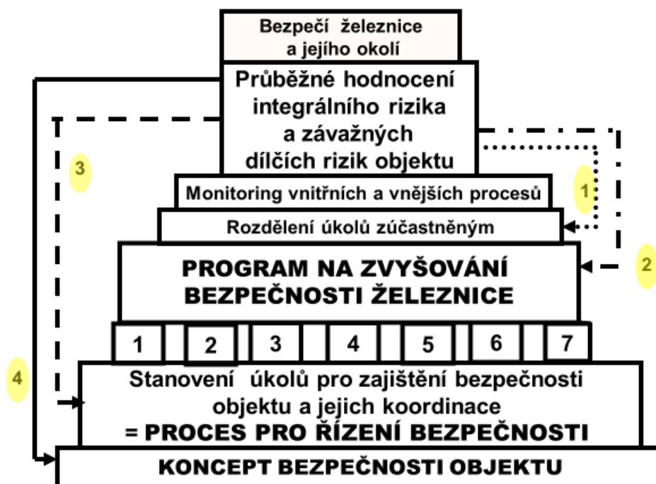
Obr. 11. Model řízení bezpečnosti železnice s automatizovaným řízením v čase. Procesy: 1- koncepce a řízení; 2 - administrativní postupy; 3 - technické procesy; 4 - vnější spolupráce; 5 - nouzová připravenost; 6 - dokumentace a šetření havárií; 7- kybernetické zabezpečení. Zpětné vazby: 1-4.
