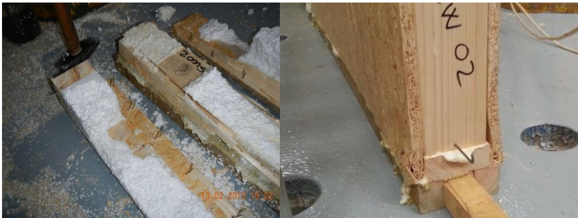
Obr. 34 Porušení v místě kotevní hlavy (vlevo), porušení v tlačené oblasti (vpravo)
