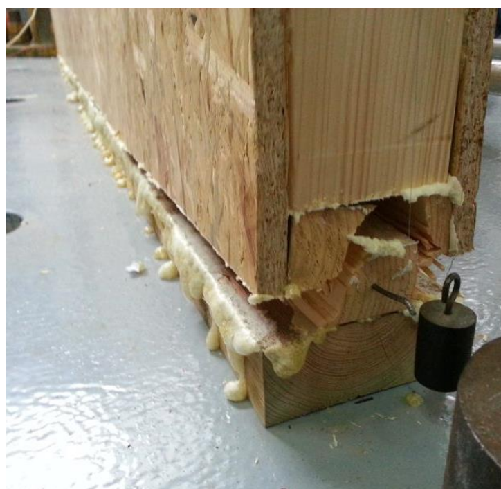
Obr. 60 Porušení spodního lemovacího prvku v tahu kolmo na vlákna
