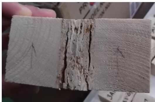
Obr. 49: Charakteristické porušení vzorku smykem v OSB desce
