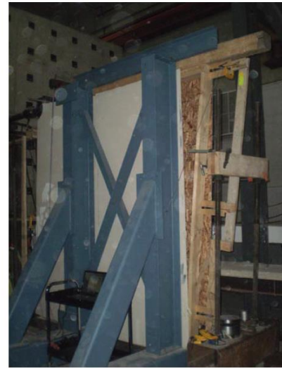
Obr. 26 Zkouška únosnosti u výtěžných stěn s cyklickým zatížením [11]
