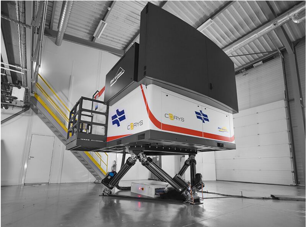
Obrázek 3.5: Plný simulátor Corys s pohybovou plošinou[17]
